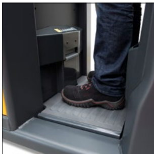
Odpružená komfortná plošina obsluhy s možnosťou individuálneho nastavenia (voliteľne)
