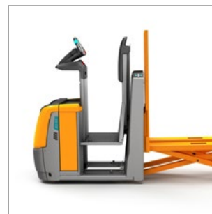
Zdvíhateľná plošina obsluhy (HP-LJ) na vychystávanie z 2. úrovne regála (voliteľne)
