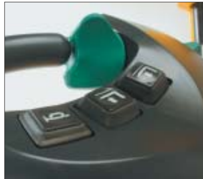
Taster für feinfühliges Heben und Senken, sowie Hupen
