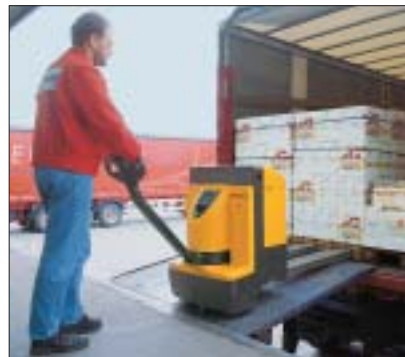
Fahrstabilität durch gefederte Stützrollen
